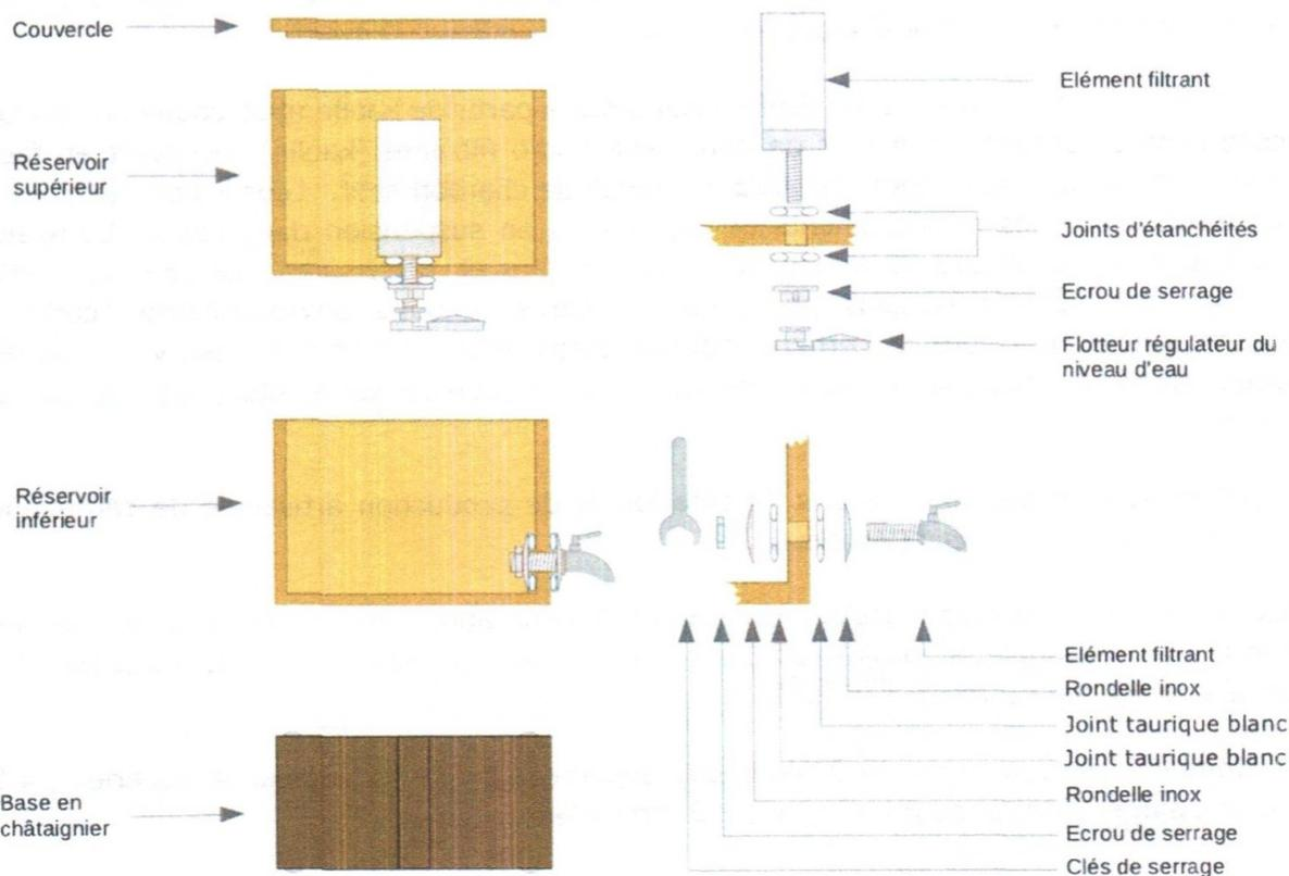
**IMPORTANT :** Lors du montage du robinet et du filtre, il est très important de faire tourner seulement l'écrou de serrage. Le blocage ne doit pas se faire en tournant le filtre ou le robinet. La fontaine dispose d'une clé de serrage pour son robinet en inox.
